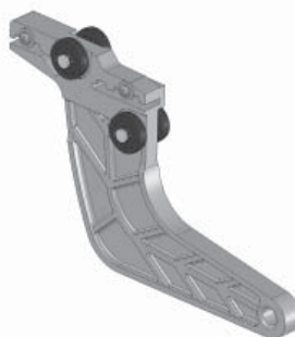
Polea brida primer palillo Sliding flange of the first fabric profile Chariot premier porte toile Polea brida primer palillo
